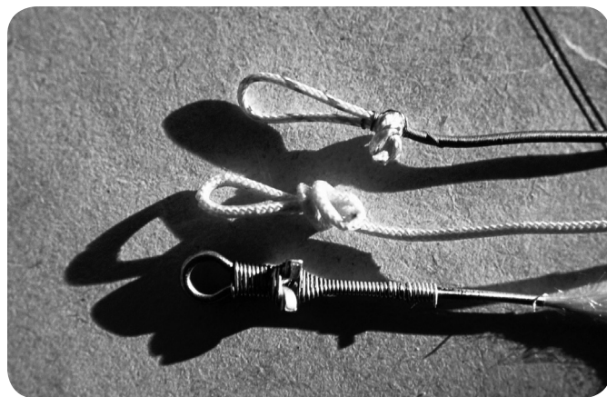
Obese nekdanjih spremnih strun. Temnejša se je po uglasitvi raztegnila v elipso. (foto: I. Zupanc)
