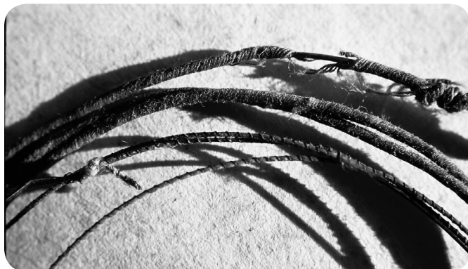
Bakrena spremna struna, gosto povita z nitko iz bombažnih vlaken in jeklena struna z bombažnimi vlakni, redko povita s tanko kovinsko nitko, sta bili predhodnici jeklene spremne strune s svilo in navitjem iz novega srebra. (foto: I. Zupanc)
